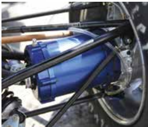
Každé kolo pohání nezávislý elektromotor s iCARe® Save
